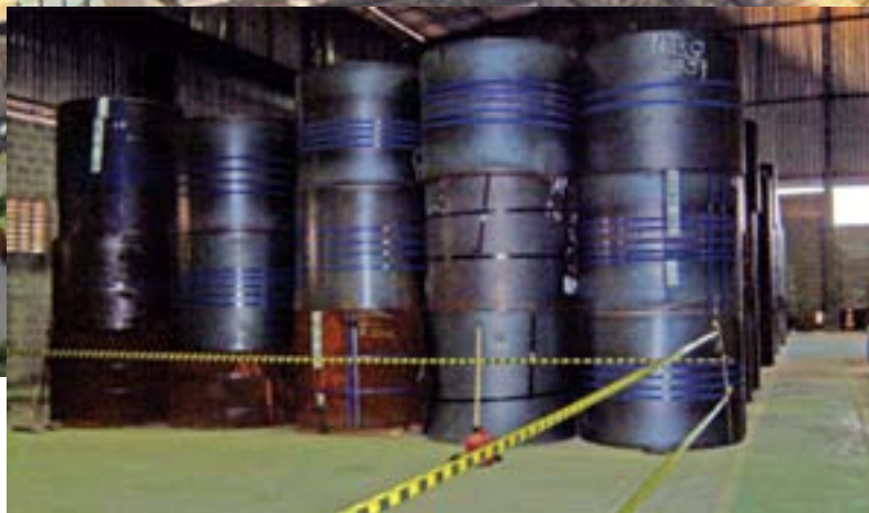
Pilhas de bobinas de aço: tensões elevadas no solo.
